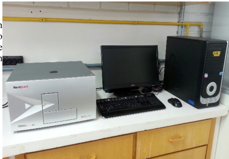
Fig.2 – Espectrofotômetro com leitor de microplaca empregado na avaliação da atividade enzimática (adquirido com recursos do INCT-MarCOI).
